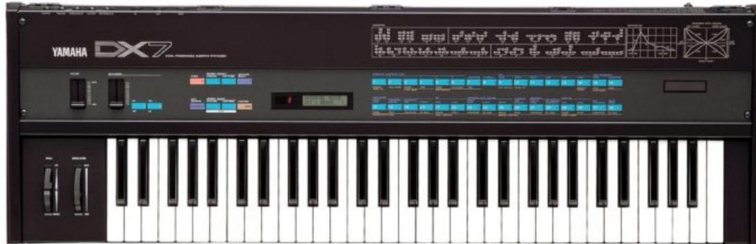
FM合成(Frequency Modulationの略)を使用して、複雑な倍音成分を生成することができるシンセサイザー。アナログシンセの操作方法を応用して使用するので、アナログシンセに関する知識を身につければ仕組み自体は簡単に理解できる。代表的なFMシンセにはYAMAHAのDX7がある。
